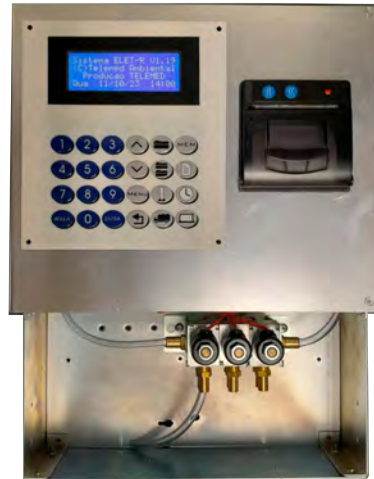
PAINEL SEM A TAMPA FRONTAL E TAMPA INTERNA FECHADA
