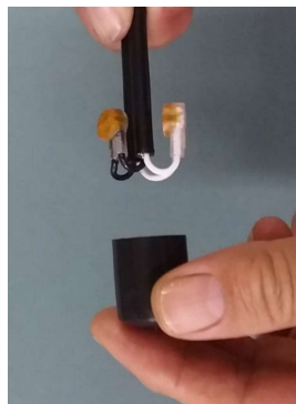
5. Inserir os conectores e preencher o espaço restante.
